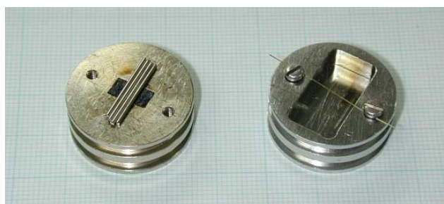
写真3 線状試料の固定方法 (color online)
